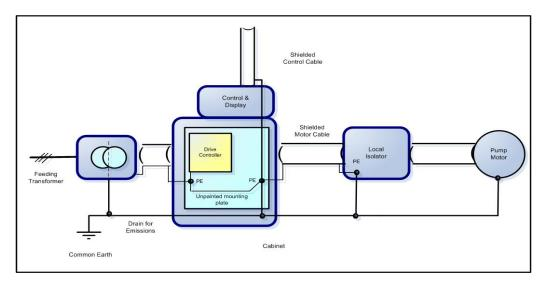
Figure 5-7 Install Equipotential Bonding
